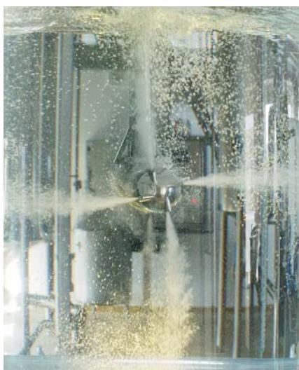
Один и тот же роторный реактивный миксер может использоваться для рассеяния газа, создания супензий или смещивания жидкостей, а также для очистки резервуара.
