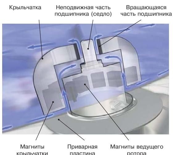
Запатентованная крыльчатка магнитных мешалок Альфа Лаваль висит в магнитном поле, что значительно снижает трение и облегчает очистку.
